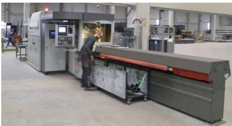
*an einem der modernen Rohrlaser werden Metallrohre bearbeitet. Foto: Fliegl*
