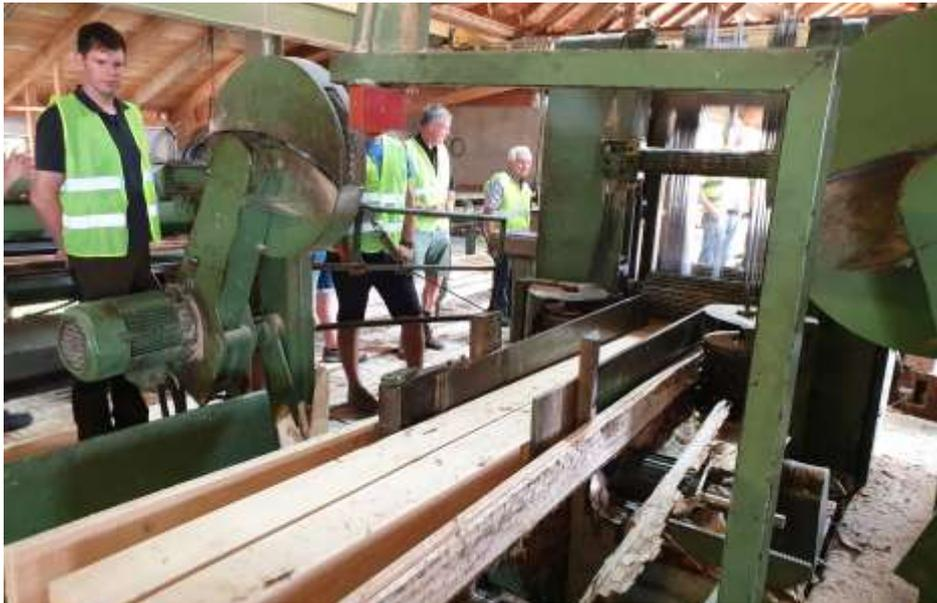
*Mit der Gattersäge ist es möglich, den Stamm in einem Durchgang in die benötigte Schnittholzware zu sägen.. Foto: Remigius Hammerl*
