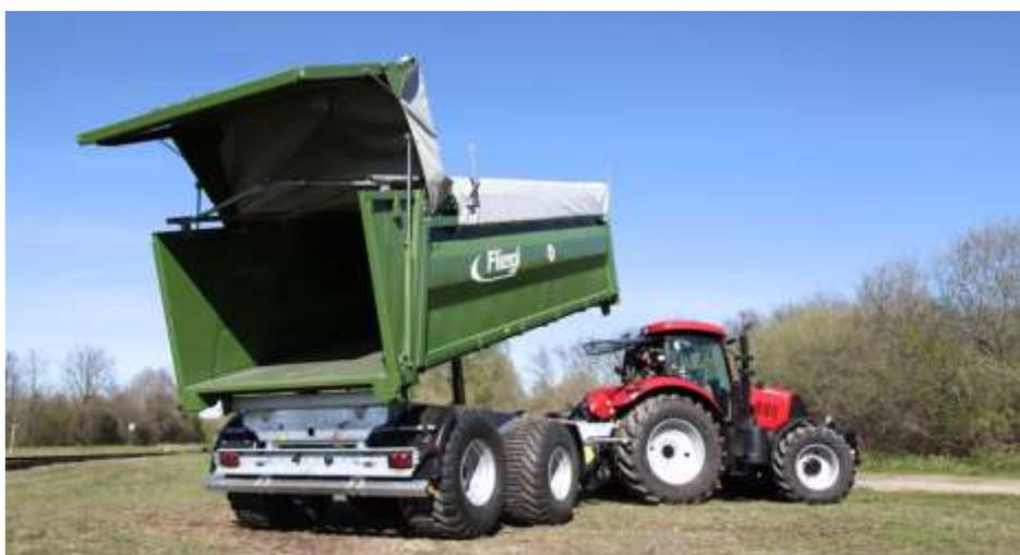
*Moderner Mulden-Dreiseitenkipper ermöglicht flexibles entladen nach links, rechts und hinten. Foto: Fliegl*
