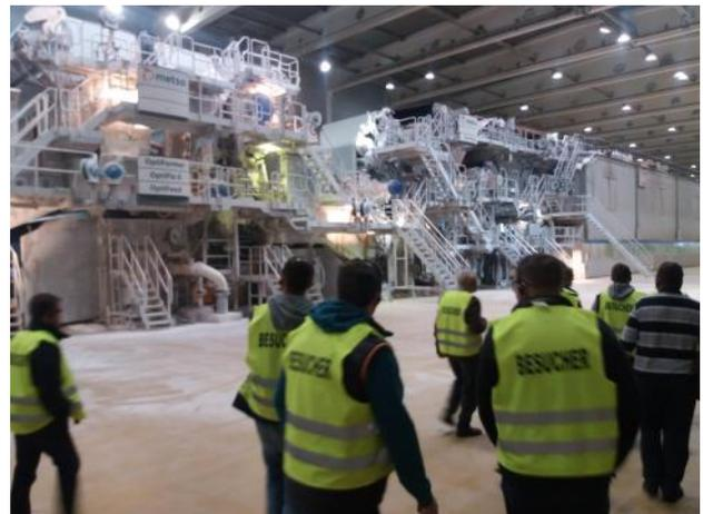
*Am Anfang der 120m langen und rund 20m breiten Papiermaschine kontrollieren Angestellte das reibungslose Arbeiten auf mehreren Arbeitsetagen.*
