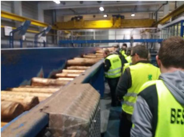
*In der Schleiferei werden die auf 1,5m abgelängten Papierholzabschnitte zu Holzstoff geschliffen.*
