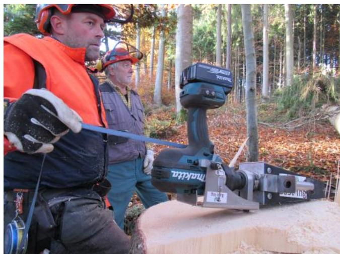
**Der Valfast kann mit Hilfe eines Forstmaßbandes auch aus sicherer Entfernung bedient werden.** Foto: Jan Röder
