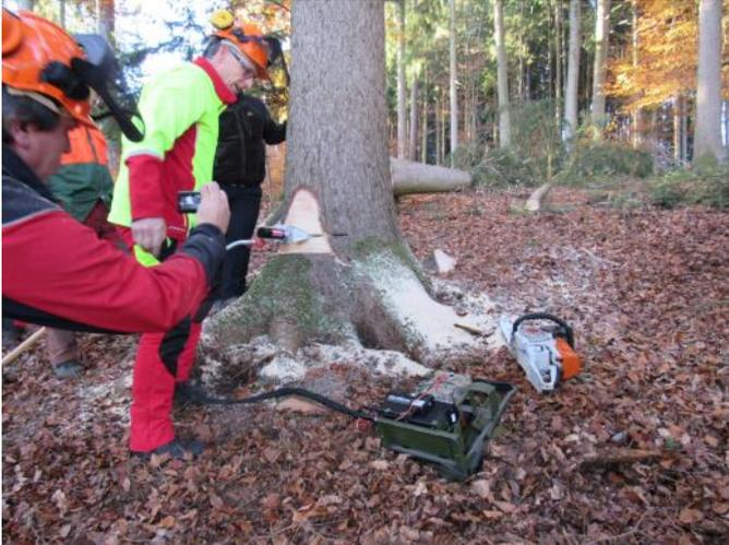
*Peter Strixner führt sein hydraulisches Fällsystem vor (vorne in der Mitte). Die Basisstation ist mit einem Schlauch mit dem Keil verbunden. Es kann sowohl per Handpumpe als auch per Funk bedient werden. Foto: Jan Röder*
